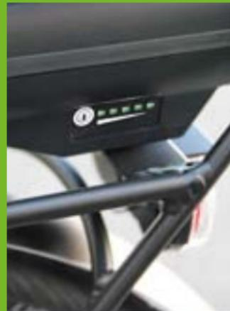
**RADCOMPUTERFUNKTIONEN** über die Taste seitlich links in einer Endlosschleife. Taste 3 Sec. gedrückt halten setzt die Tourwerte auf 0.
